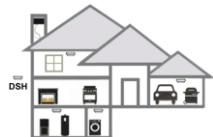
От правильности размещения датчика DSH будет зависеть то, насколько своевременно устройство среагирует на пожар и насколько хорошо люди услышат сигнал тревоги. Установите датчик в каждой комнате, где кто-то спит с закрытой дверью. Закрытая дверь может препятствовать тому, чтобы датчик, находящийся вне этой комнаты, разбудил спящего человека. Для спален, прихожих или больших помещений длиной более 12 м установите датчики на обоих концах комнаты или коридора.
