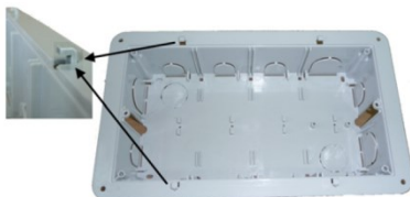
Рис. 1. Короб для крепления в стену. Удалите 4 клипсы, выступающие на бортиках короба.
