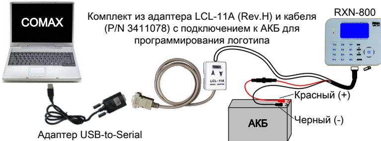
Рис.4. Схема подключения клавиатуры RXN-800 к ПК для загрузки логотипа
