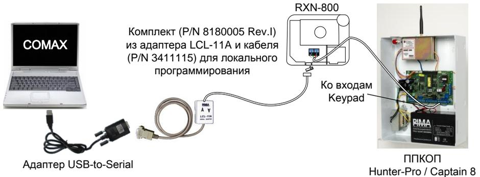
Рис.5. Схема подключения ППКОП к ПК для локальной загрузки/считывания
