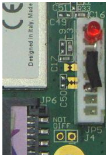
Figura 12. Conector de LED de intensidad de señal
