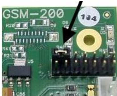
Figura 7. Jumper para seleccionar la frecuencia a 850MHz/1900MHz
